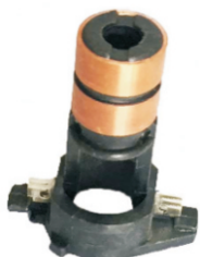
A-217 COLECTOR DE ALTERNADOR A:7 B:15,90 C:51,80
